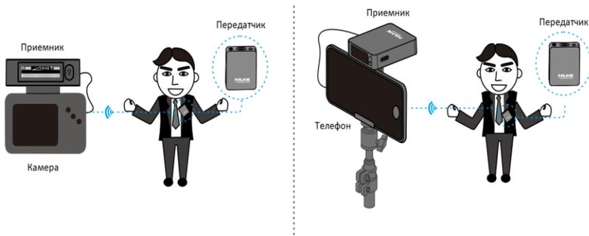
Включите питание передатчика. Коротко нажмите кнопку питания передатчика, чтобы переключить режим: MUTE (светодиод горит КРАСНЫМ)/ NORMAL (светодиод горит ЗЕЛЕНЫМ). Включите питание приемника, коротко нажмите кнопку питания, чтобы последовательно отрегулировать ВЫХОДНОЙ УРОВЕНЬ: 0dB/+6dB/+12dB/-12dB/-6dB. По умолчанию ВЫХОДНОЙ УРОВЕНЬ равен 0dB.
